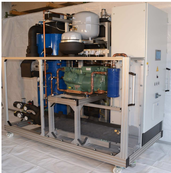
Kaltsolebereiter zur Versorgung der Multimedienkonditionierung mit 35 kW / -35°C
